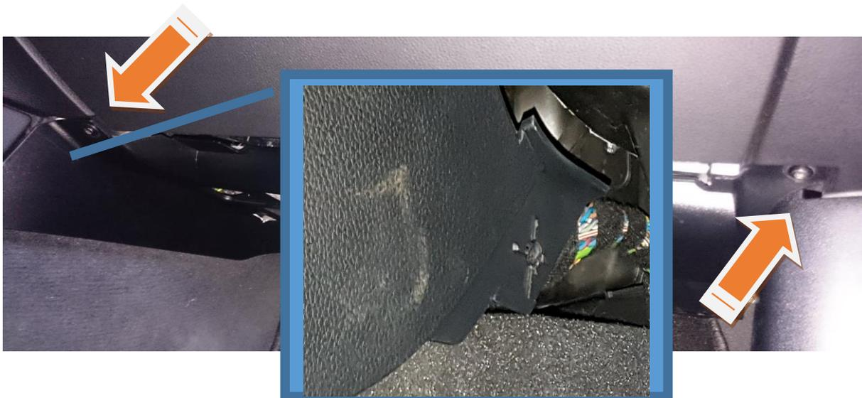
Die Abdeckung kann jetzt vorsichtig abgelassen werden. Achtung, es ist noch eine Steckverbindung der Fußraumleuchte zu trennen.
