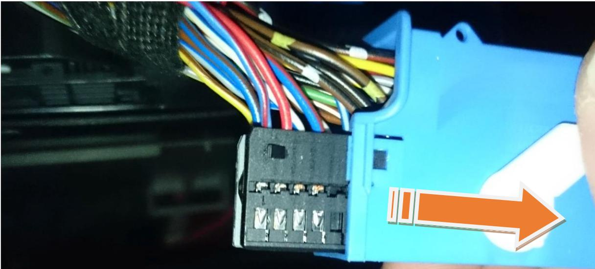
Jetzt werden die Kabel Pin 1 (CAN\_High mit der Farbe Rot/Blau) sowie Pin 2 (CAN\_Low mit der Farbe Rot) ausgepinnt. Dazu einen kleinen Flachsraubendreher, eine Nadel oder etwas ähnliches verwenden. Die Crimp-Kontakte haben eine Fahne welche wie ein Widerhaken funktioniert. Diese Fahne muss gedrückt werden und gleichzeitig vorsichtig am Kabel gezogen werden. Achtung: die Fahne kann ein zweites mal einrasten in der Zwischen-Öffnung. Hier muss erneut gedrückt werden.
