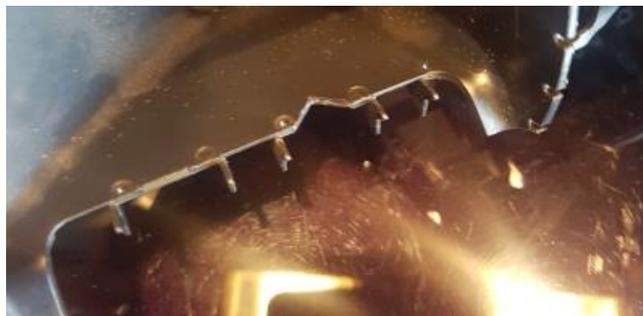
Das Display erst in die Frontblende einsetzen und dann die „Laschen“ der Frontblende vorsichtig in das Gehäuse einfädeln. Darauf achten dass das Display mit dem angeschlossenen Displaykabel in Position bleibt. Es empfiehlt sich erst die Unterseite der Frontblende vorbei an den Luftleitführungen einzufädeln und dann die Frontblende an der Oberseite einzuklappen.
