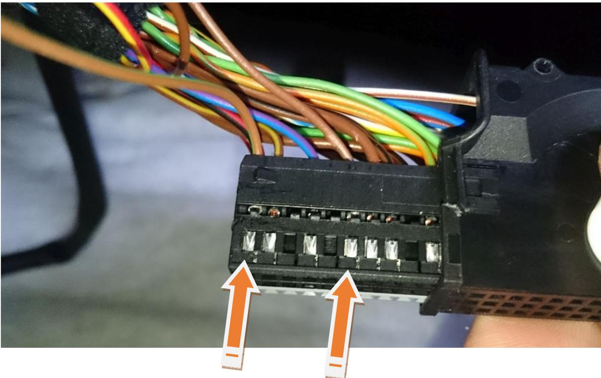
Wenn die Kontakte in die mitgelieferten Buchsengehäuse gesteckt wurden muss noch der Verriegelungsbügel daran gedrückt werden bis er einrastet.
