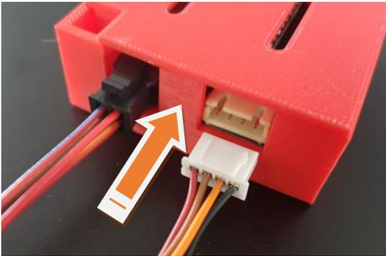
Wenn alle Kontakte und Stecker verbunden sind kann der Kabelbaum an den Controller gesteckt werden.
