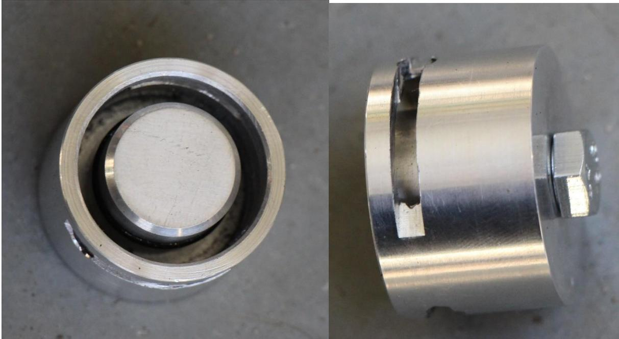
5. Der Verschlussstopfen muss nun über den Flansch an der Ansaugbrücke geschoben werden. Auch hier müssen Sie auf Sauberkeit und Funktionalität der Dichtflächen achten.
