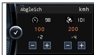
Der Geschwindigkeitsabgleich dient dazu, die tatsächliche Geschwindigkeit des Fahrzeugs mit den Signalen die das DataDisplay nutzt abzugleichen. So wird sichergestellt das die Zeitmessungen auch exakt sind.
