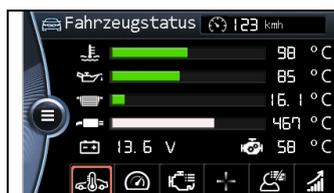
Zeigt diverse Temperaturen, Geschwindigkeit (abgeglichen) und die Boardspannung.
