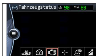
Hier werden Motorabhängig diverse Daten wie Lambda, Benzindruck, Raildruck, Öldruck usw. angezeigt.
