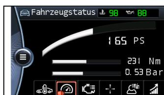
Diese Seite zeigt die Leistung, das Drehmoment sowie den Ladedruck (bei Saugermotoren die Luftmasse)
